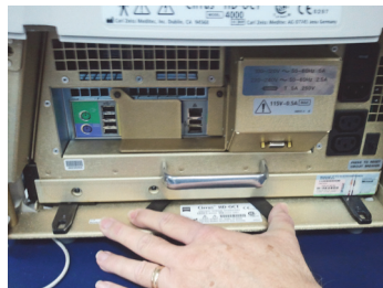
Figura 5-2: Destravamento e deslizamento para fora da bandeja do computador (Modelo 4000)
