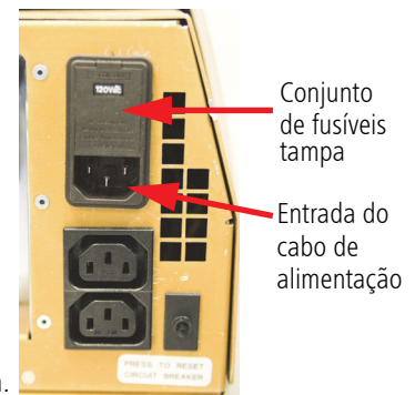
Figura 5-3: Bandeja do computador totalmente para fora, fornecendo acesso ao conjunto de fusíveis (Modelo 4000)
