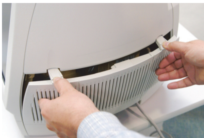
Figura 5-1: Remoção da tampa traseira 2660021156661 Rev. B 2015-09
