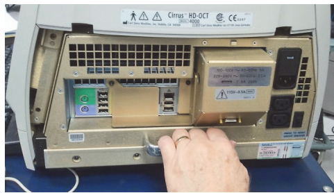
Figura 5-3: Bandeja do computador totalmente para fora, fornecendo acesso ao conjunto de fusíveis (Modelo 4000)
