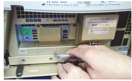
Figura 5-2: Destravamento e deslizamento para fora da bandeja do computador (Modelo 4000)
