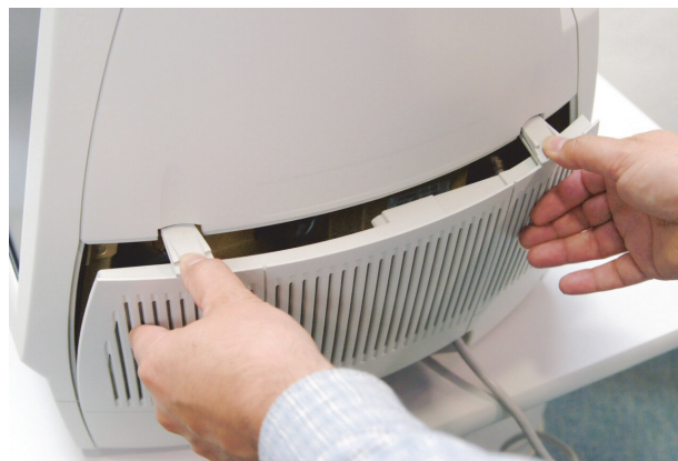
Figura 1-2: Removendo a tampa traseira (a aparência exata depende do modelo e ano)
